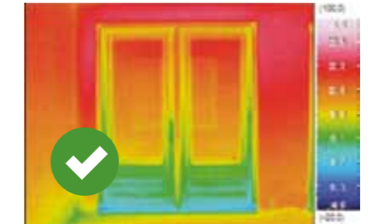
Dubbele tuindeur van binnen-uit. Egaal warmtebeeld, zichtbaar op infraroodfoto.
